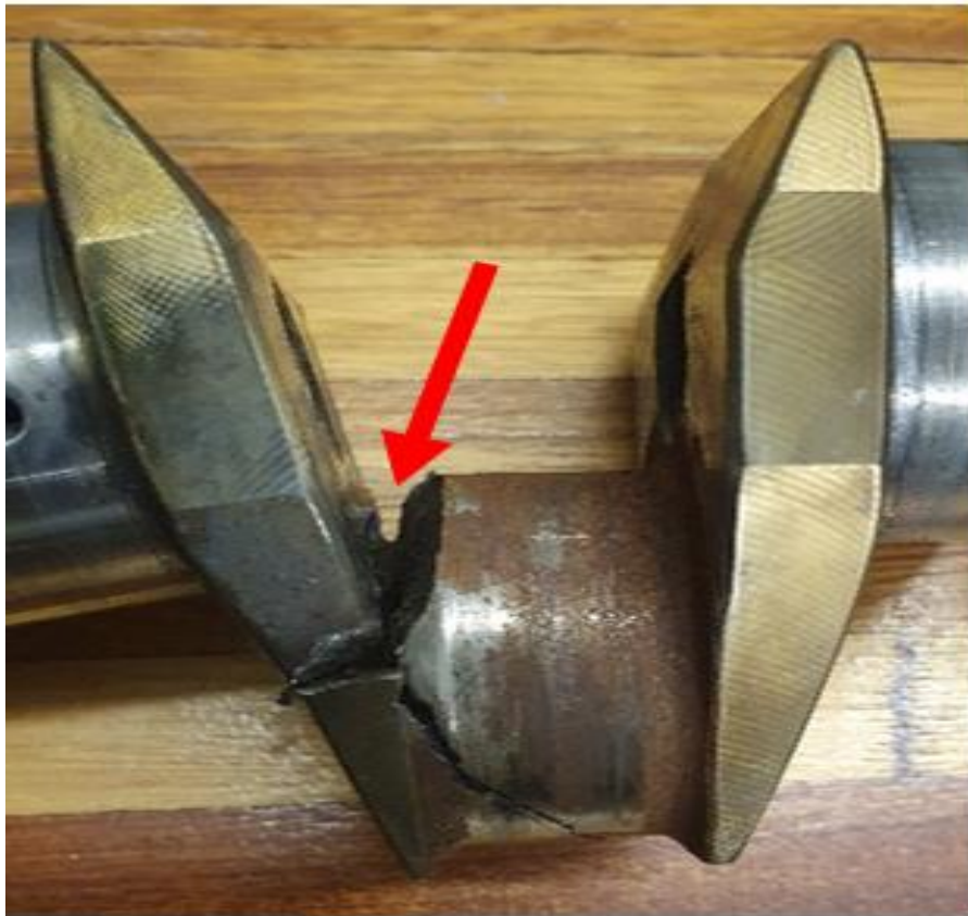
Photo 3: Conrod fracture position (digital).
